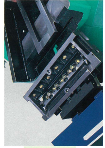
④刃先先端をセッチングゲージ当ててあとはボルトを締めるだけ。だれでも一度で美しいかんな肩を出すことができます。
