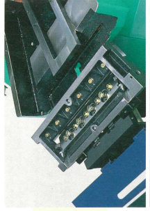
④刃先先端をセッティングゲージ当ててあとはバルトを締めるだけ。だれでも一度で美しいかんなんを出せます。
