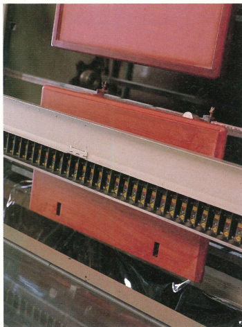
丸伸独自の材検知装置により、塗料のムダを最小限におさえます。
