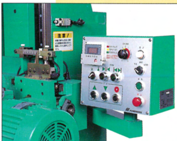
▲操作パネル部(主軸電流表示付)
