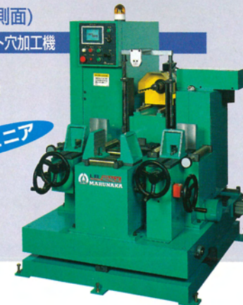
17 LB-155V 上3軸下2軸穴加工機 (上面+下面)
