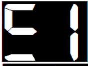
電源投入時に、起動、停止、刃先合わせ、動作飛び越し、研削繰り返しのスイッチが押されていた場合
