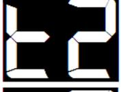
ダイヤ荒逃がし時、下限リミットOFF後、設定値になる前に、上限リミットがONした時
