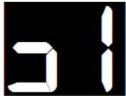
刃物セット・始動を押した時、平砥荒の上限リミットと刃物検出リミットが入っている時
